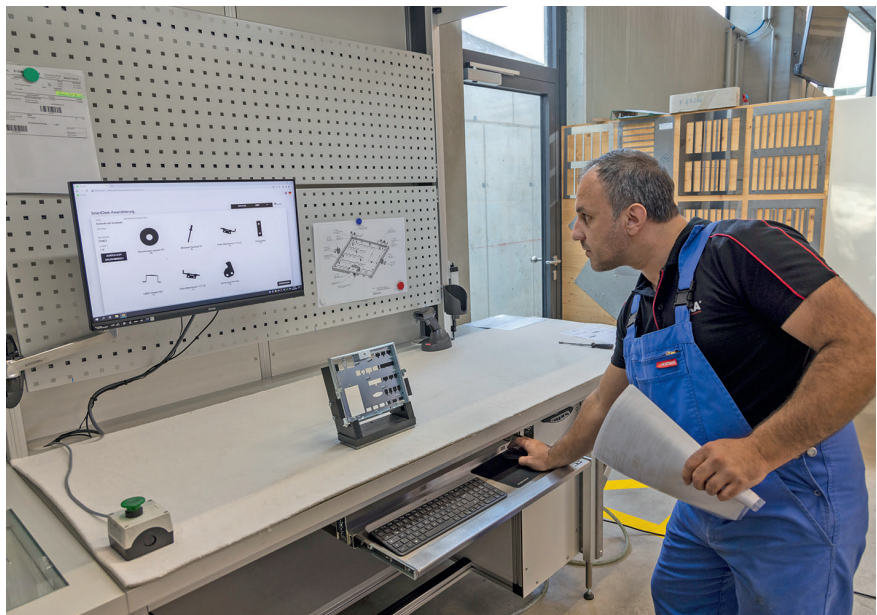
Mit Hilfe des Ivii Smartdesk lassen sich Montageschritte einfach überprüfen. Die Einarbeitung neuer Kollegen wird erleichtert. © ivii GmbH
